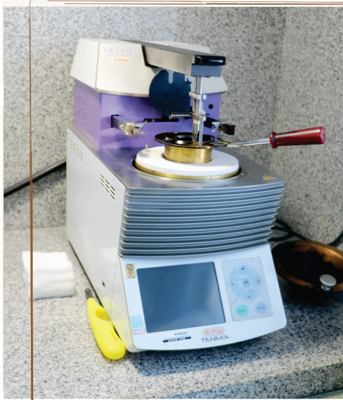
Апаратът за автоматично определяне на пламна температура в открит тигел по метода на Cleveland, модел ACO 8, производство на TANAKA Япония, е в експлоатация от 2013 г. Той измерва и показва свойствата на пробата, подложена на нагряване и тестов пламък при контролирани условия.
