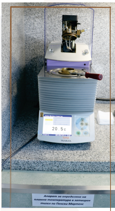
Апаратът за определяне на пламна температура в затворен тигел по метода Pensky – Martens, модел ATM 8 на TANAKA, Япония измерва най-ниската температура, при която прилагането на тестов пламък причинява запалване на парите от пробата на различни потенциално запалими течности.
