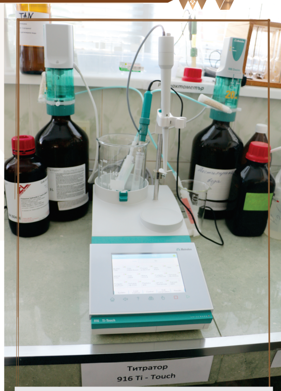
Потенциометричната титрувална система, модел 916 Ti Touch на Metrohm, Швейцария, измерва така наречените алкално число (TBN) и киселинно число (TAN) на различни видове масла и горива.
