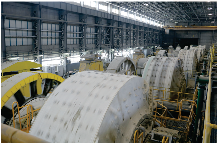
Новият шести дезинтегратор работи в тестов режим
