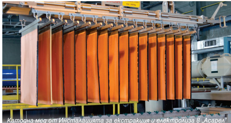
Катодна мед от Инсталацията за екстракция и електролиза в „Асарел“
